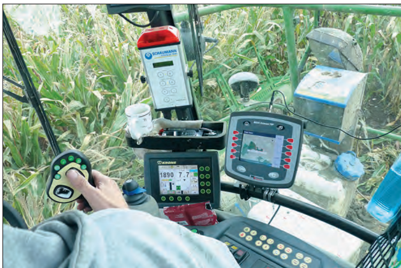
Das Leitfahrzeug einer Arbeitskette sollte über einen großen Monitor verfügen, um Aufträge sicher abzarbeiten.
